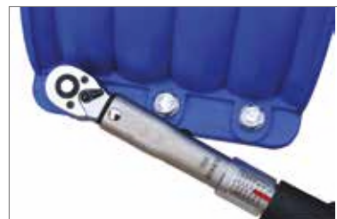
Empfohlene Spannung mit Drehmomentschlüssel, Anzugsmoment 10N für Schrauben M8 und 22N für Schrauben M10, um eine hermetische Abdichtung zu gewährleisten.
