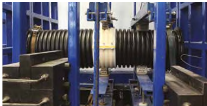
Dichtheitsprüfung bei versetzter Verbindung
