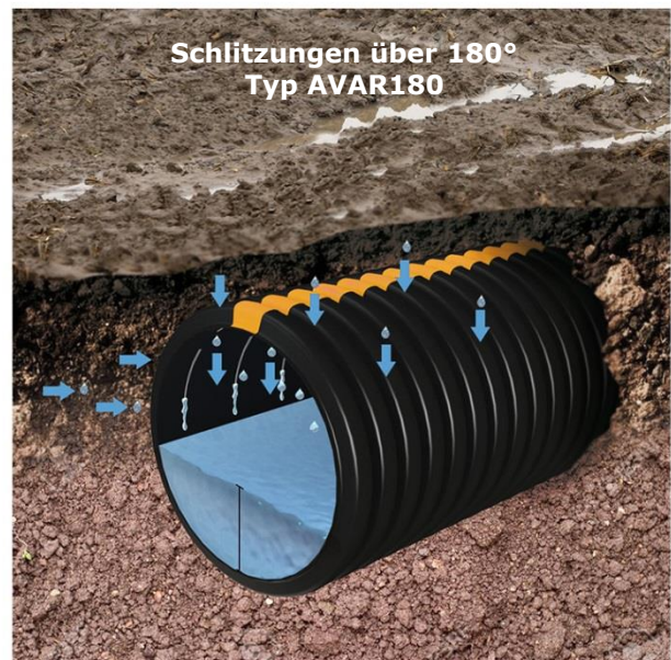
Schematische Darstellung Drainagefunktion bei voll- oder teilgeschlitzten Rohre
