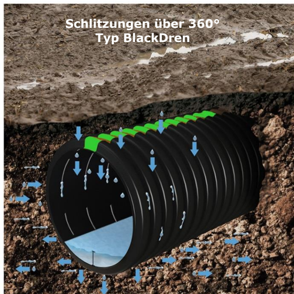
Schematische Darstellung Drainagefunktion bei voll- oder teilgeschlitzten Rohre
